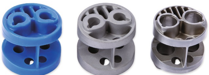
Bild 3: Das Wachsmmodell des Spaceball, der Rohguss und das bearbeitete Gussteil vor dem Versand an Neander Shark.
